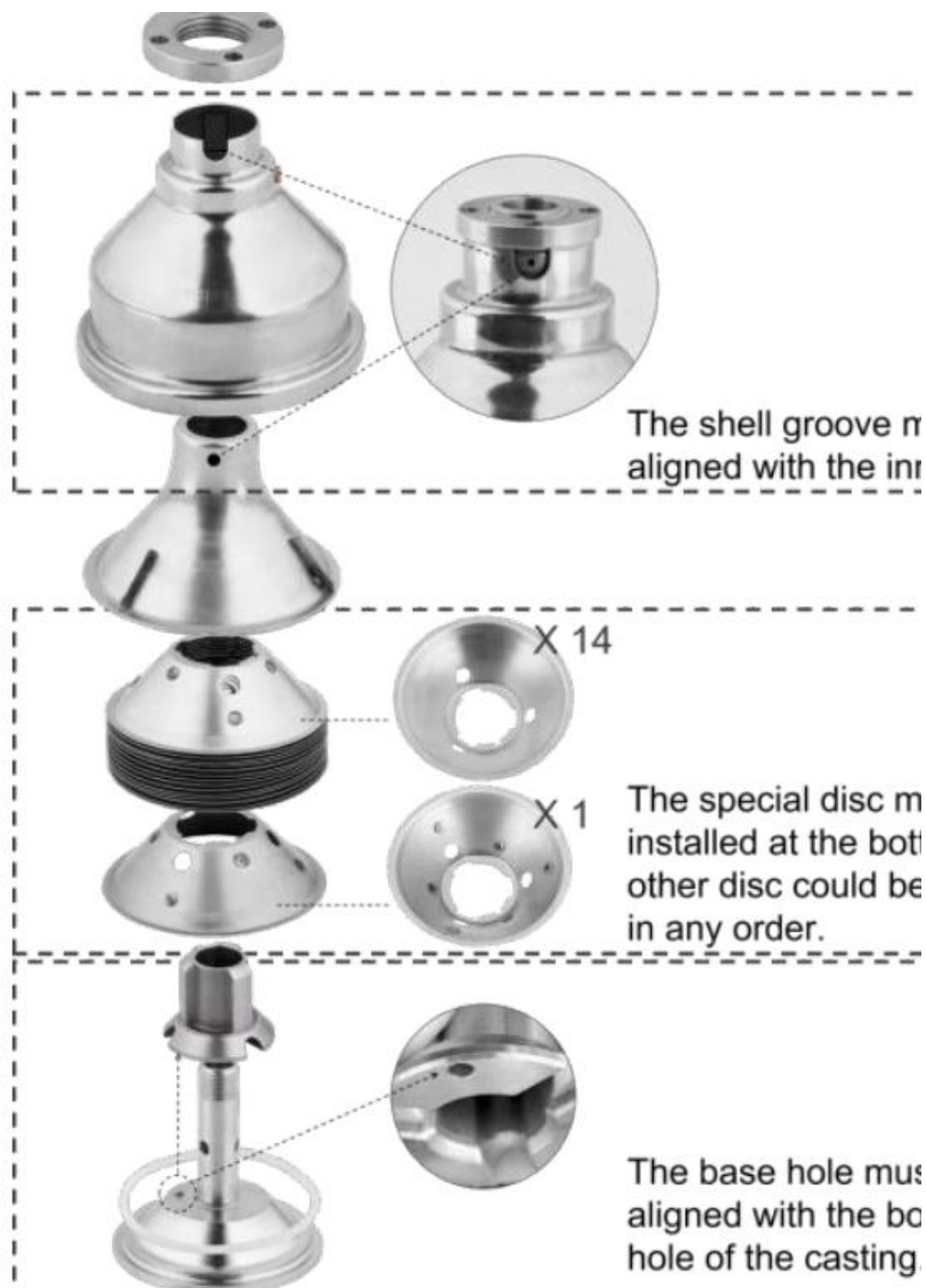
Σχήμα 5 – Διάταξη και σωστή τοποθέτηση των εξαρτημάτων του μπολ διαχωρισμού
