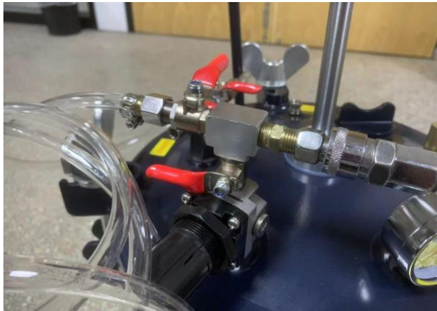
Σύνδεση του συνδέσμου εισαγωγής αέρα και άνοιγμα της βαλβίδας εισαγωγής.
