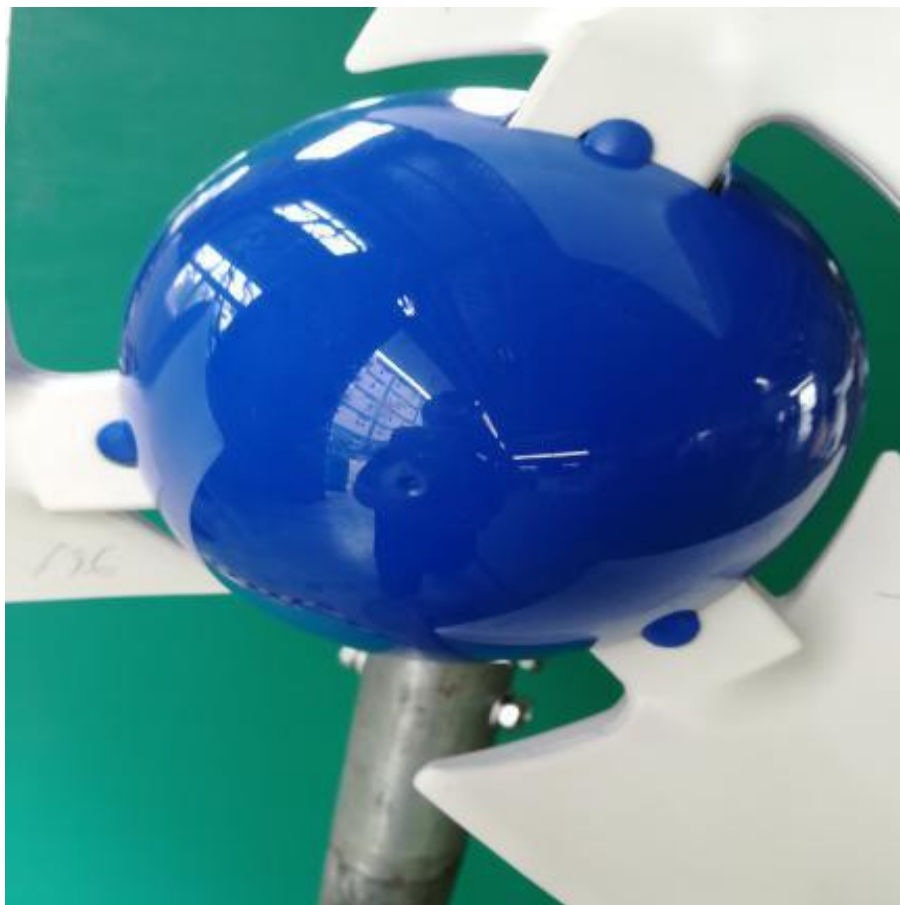
Σχήμα 10 – Τοποθέτηση και ασφάλιση της πλήμνης/καλύμματος.
